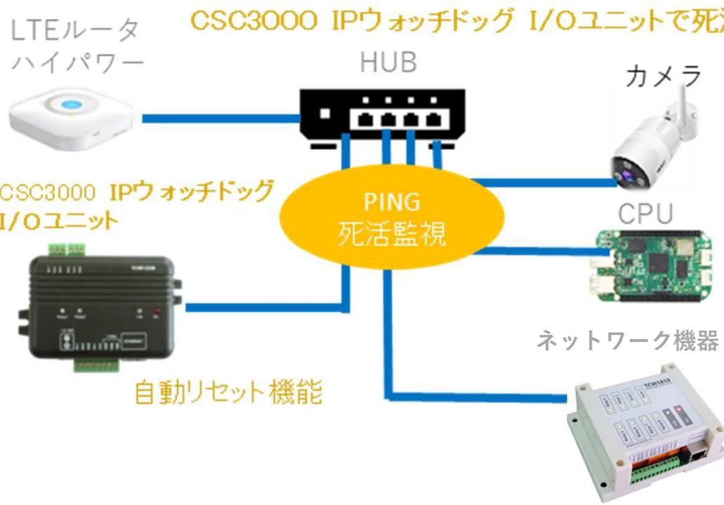
CSC3000 IPウォッチドッグ I/Oユニットで死活監視・自動リセット 手動OFF-ON
