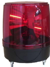
定格電圧 AC100V 電流 0.32A 保護等級 IP23 閃光数 180回/分 電球 120V 40W 質量 0.9kg コンセントプラグ付ケーブル 公称断面積 0.75mm<sup>2</sup> 線種 VCT 引出し線長 450mm
