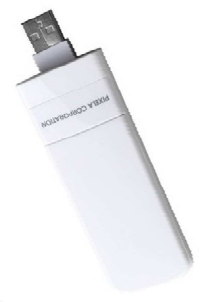
無線LTE回線 dongle センサーのUSBに接続
